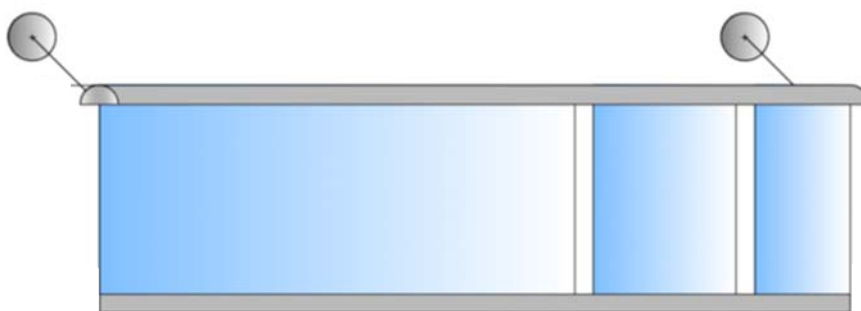
Bild 8 Variante \gamma : Ausführung mit durchgehendem Handlauf und seitlicher Endanbindung des Handlaufs
