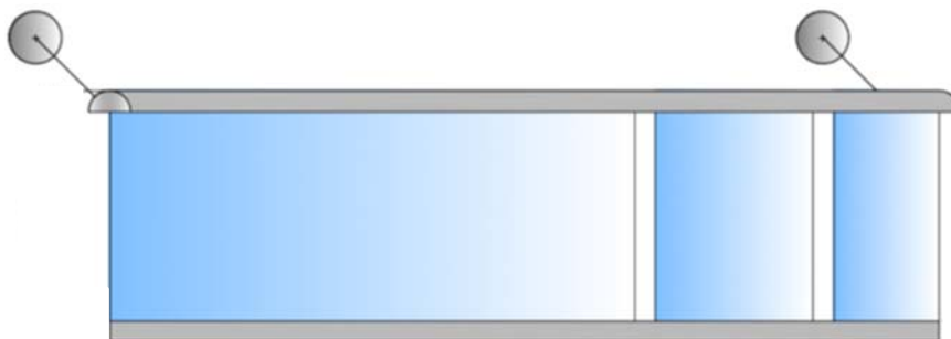
Bild 9 Variante \gamma : Ausführung mit durchgehendem Handlauf und seitlicher Endanbindung des Handlaufs
