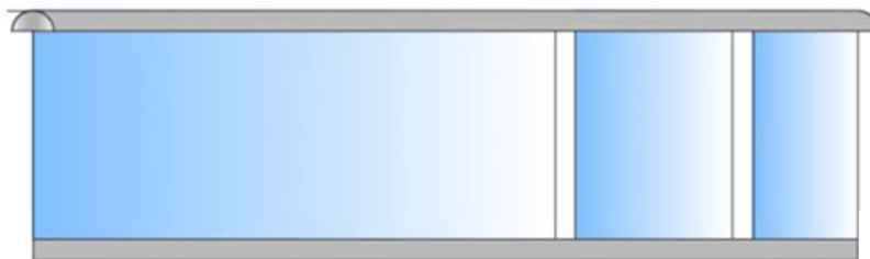
Bild 8 Variante \beta : Ausführung mit durchgehendem Handlauf
